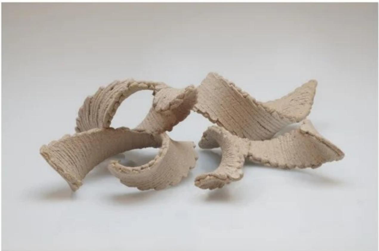
**Figura 6.** Bacello in legno deformato stampato in 3D. Questi sono stati realizzati stampando su nastri elicoidali di chiralità opposta con un angolo relativo di 45°.
